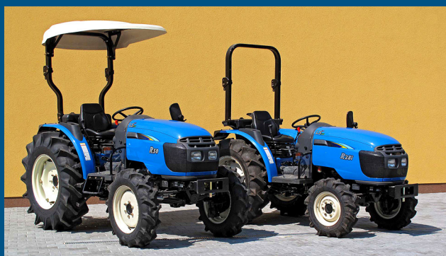
Model R36r - vytápěná kabina a čelní nakladač jsou prvky volitelné výbavy
